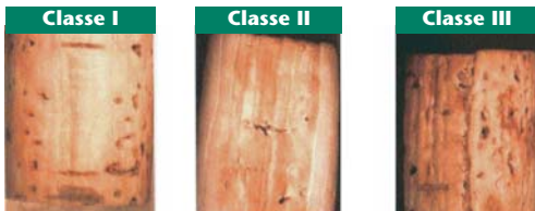
Figure 8- Classification des bouchons après le test de résistance à la pression hydrostatique
